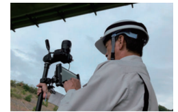
Trimble SightFusion (ひび割れ画像計測ソリューション) 橋梁点検支援として画像処理技術と AIを活用した新技術で、橋梁点検作業の 負担を軽減、効率化実現
