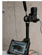
Trimble SightFusion (ひび割れ画像計測ソリューション) 橋梁点検支援として画像処理技術と AIを活用した新技術で、橋梁点検作業の 負担を軽減、効率化実現
